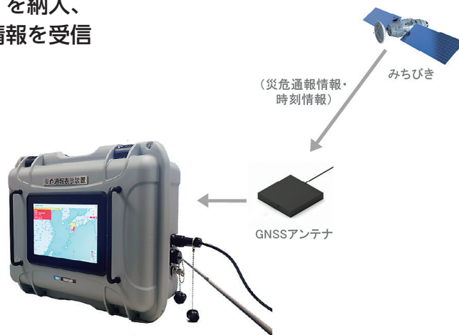
災危通報表示装置
